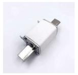
4. 快速熔断器:主要用于半导体整流元件或整流装置的短路保护。由于半导体元件的过载能力很低,只能在极短时间内承受较大过载电流,因此要求短路保护具有快速熔断能力。快速熔断器的结构和有填料封闭管式熔断器基本相同,但熔体材料和形状不同,是以银片冲制的有 V 形深槽的变截面熔体。
