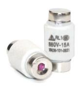
3. 有填料密闭管式熔断器:分瓷插座、铁插座和铝插座 3 种。熔管采用石英砂为填料。熔体熔断时,在电流作用下,石英砂膨胀使熔管断裂。适用于有易燃易爆物或带电粉尘场所。
