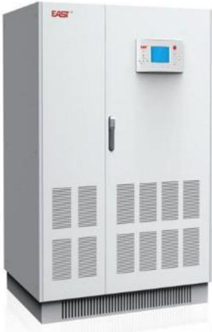
UPS (Uninterruptible Power System), 即不间断电源, 是一种含有储能装置, 以逆变器为主要组成部分的恒压恒频的不间断电源。主要用于给单台计算机、计算机网络系统或其它电力电子设备提供不间断的电力供应。电网电源存在至少九种问题: 断电、雷击尖峰、浪涌、频率震荡、电压突变、电压波动、频率漂移、电压跌落、脉冲干扰; 因此从改善电源质量的角度来说给电子设备系统配备一台 UPS 是十分必要的。另外, 精密的网络设备和通信设备是不允许电力有间断的, 以服务器为核心的网络中心要配备 UPS 是不言而喻的, 即使是一台普通电脑, 其使用三个月以后的数据文件等软件价值就已经超过了硬件价值, 因此为防止数据丢失而配备 UPS 也是十分必须的。
