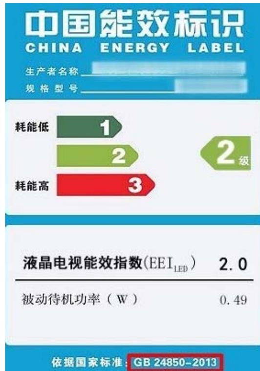
按照国家规定,现在市面上的彩色电视机都已经根据最新的能效标准进行了测量评级,贴有能效标识。能效等级分为三级,1级能效最节能,2、3级能效依次降低。在电源接通,电视未开机时的耗电功率称为待机功率。待机功率在能效标识上有标注。选择能效级别高、待机功率低的彩色电视机会为未来使用剩下不少电费。
